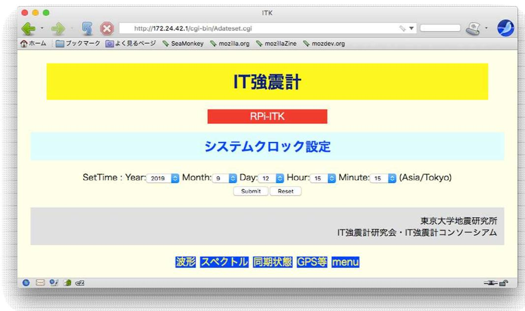
インターネット接続も GPS も無いときは RTC が頼りですが、RTC の時刻がずれてしまったときに、強制的に時刻設定することができます。
