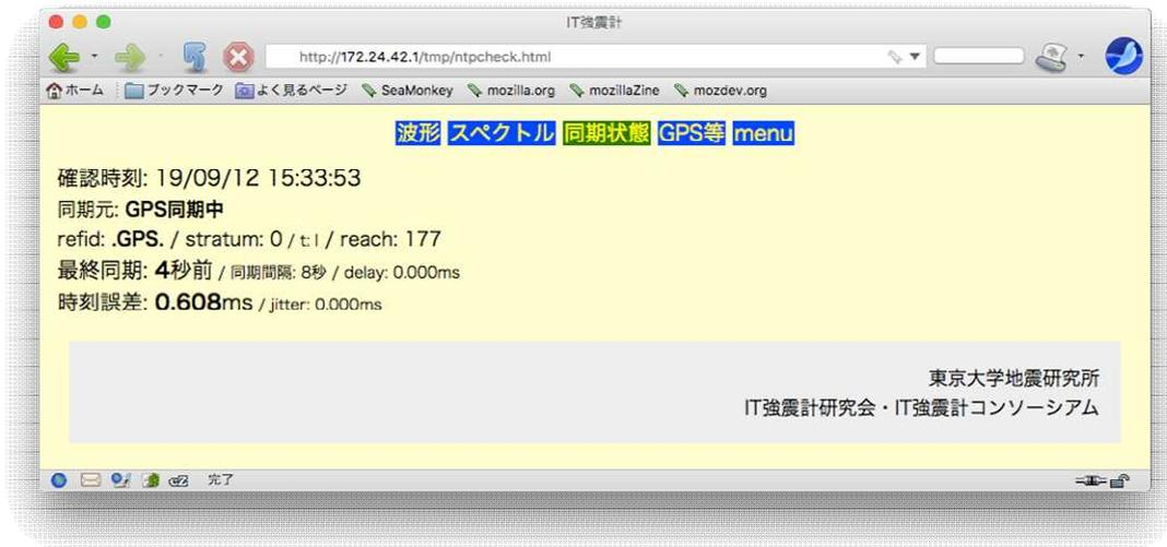
時刻同期の状態を表示します。ntpq -p で参照先となっているもののステータスを抽出しています。上は、GPS同期中のものです。
