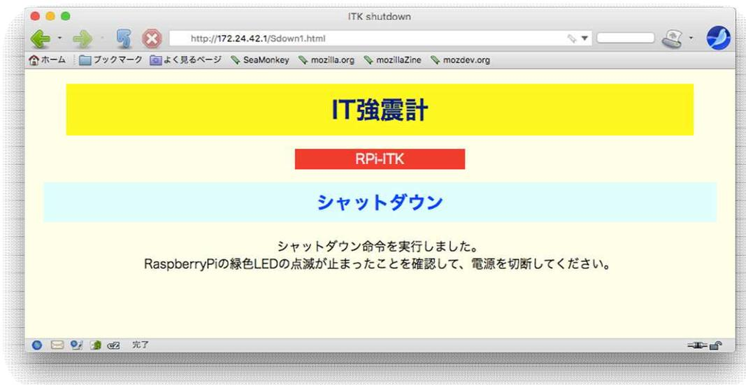
Web 画面からシャットダウン操作が行えます。シャットダウンが始まると、ファイルシステムを閉じるため RaspberryPi の緑色 LED が点滅を始めます。点滅が終了したら、電源を切ってください。
